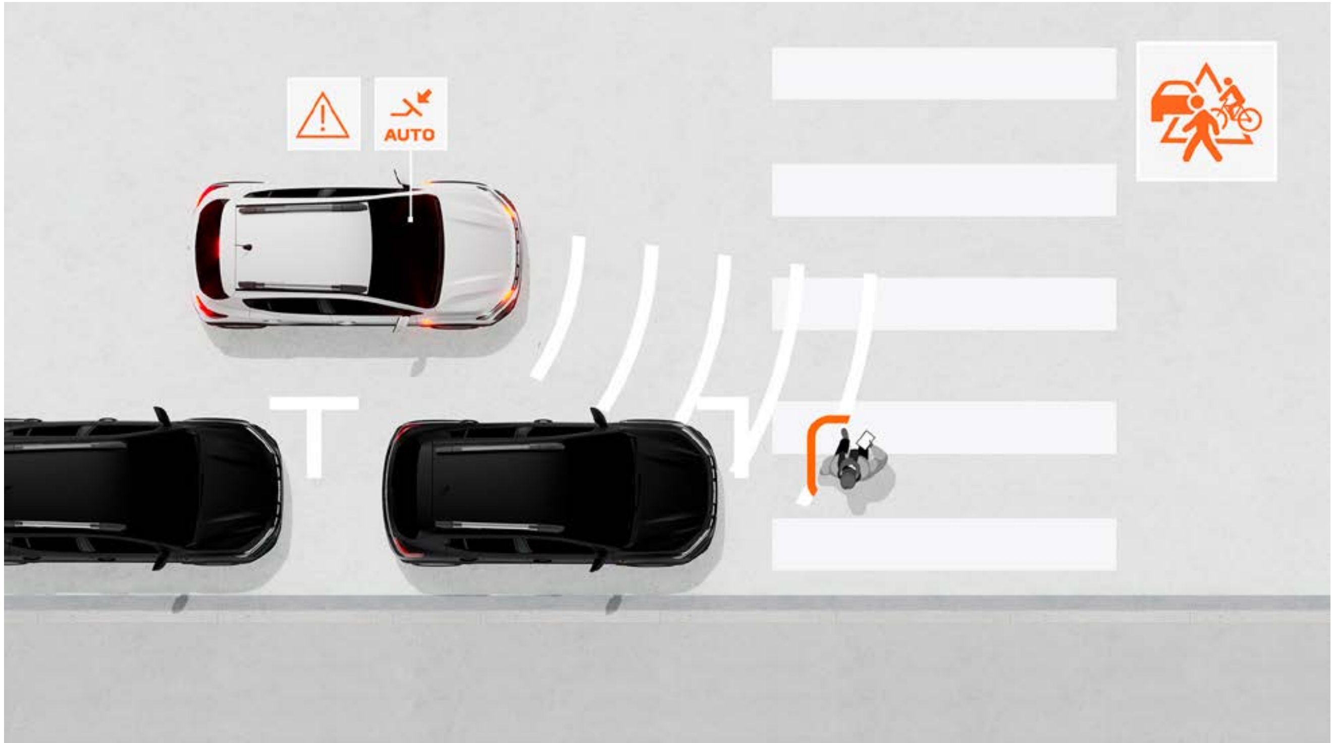
FREINAGE AUTOMATIQUE D'URGENCE (AEBS) AVEC DÉTECTION DES PIÉTONS ET CYCLISTES Ce système prévient les risques de collision frontale impliquant d'autres véhicules, des piétons ou des cyclistes, en ligne droite ou aux intersections. Il alerte le conducteur et peut au besoin freiner automatiquement le véhicule.
