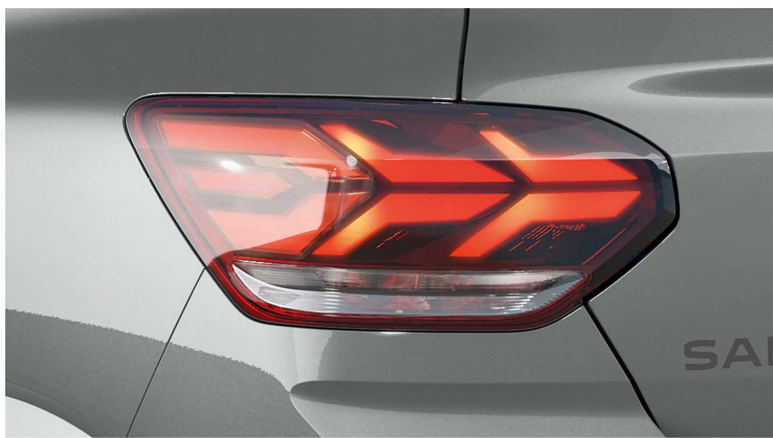
Signature lumineuse arrière en Y à LED
